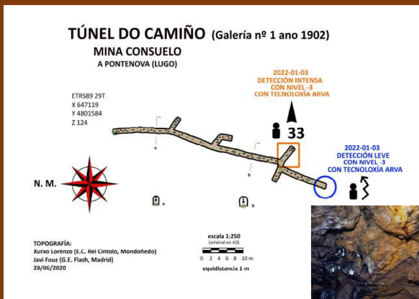
Puntos de detección del ARVA en el "Túnel del Camino" (enero 2022)
