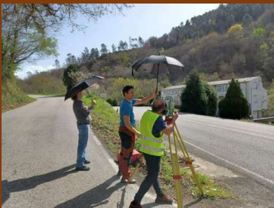
Geoposicionamiento de precisión por equipo GPS y estación total, el 27/03/2022
