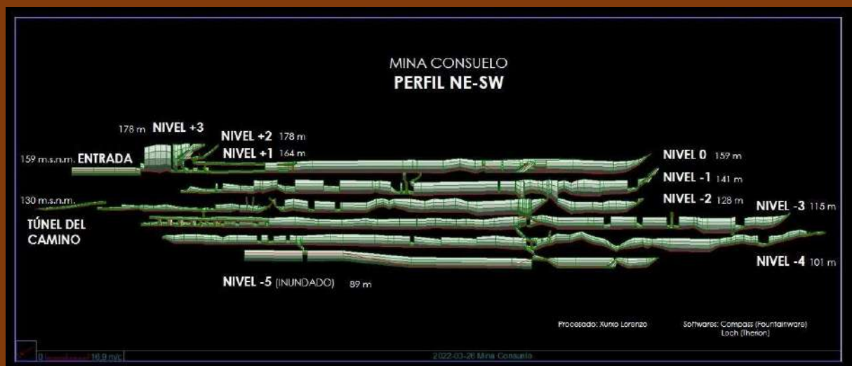
alzado de Mina Consuelo y Túnel del Camino, perfil NE-SW modelo digital 2D - Compass Cave Survey software (processado Xurxo Lorenzo, 2022)
